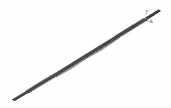
图 6 高速铁路长大桥梁 CRTS I 型双块式无砟轨道无缝线路整体计算模型
