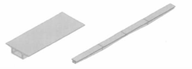
图 4 简支梁和连续梁实体单元模型
