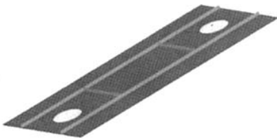
图 11 横隔板构造图
