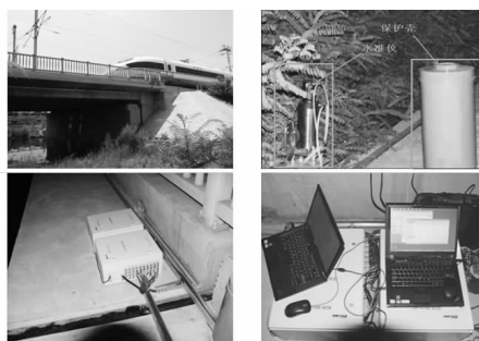
图9 线上沉降传感器(静力水准仪)和采集单元的安装
