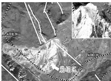
图4 断裂带内崩塌灾害发育
