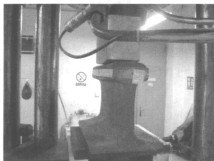
图 6 钢轨涂层抗压试验
