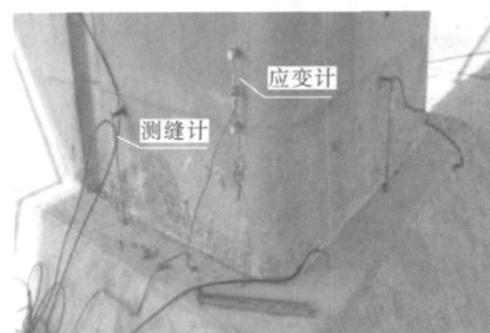
图 8 墩梁节点处布置的测缝计和应变计
