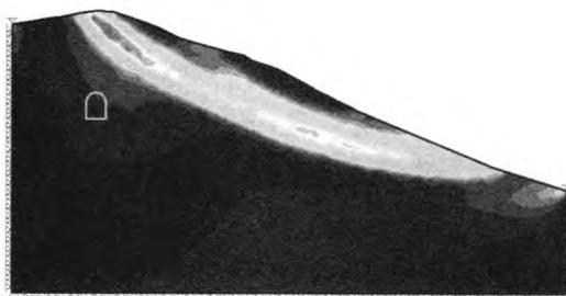
图3 潜在滑动面示意图(坡脚开挖前)
