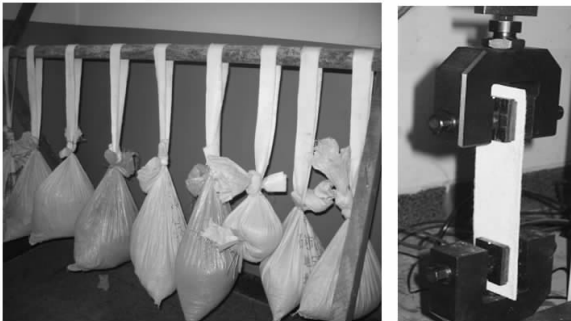
(a) 长期张拉试验 (b) 力学强度测试
