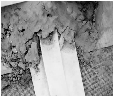
图3 半埋藏在盐渍土半暴露在空气中的土工布
