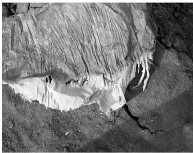
(b) 两布一膜土工布的迅速老化现象
