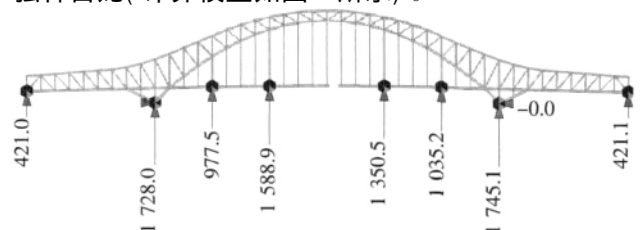
图8 下弦杆合龙工况计算模型(单位:t)
