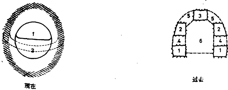
图16 尽可能全断面开挖，局部开挖损害围岩
