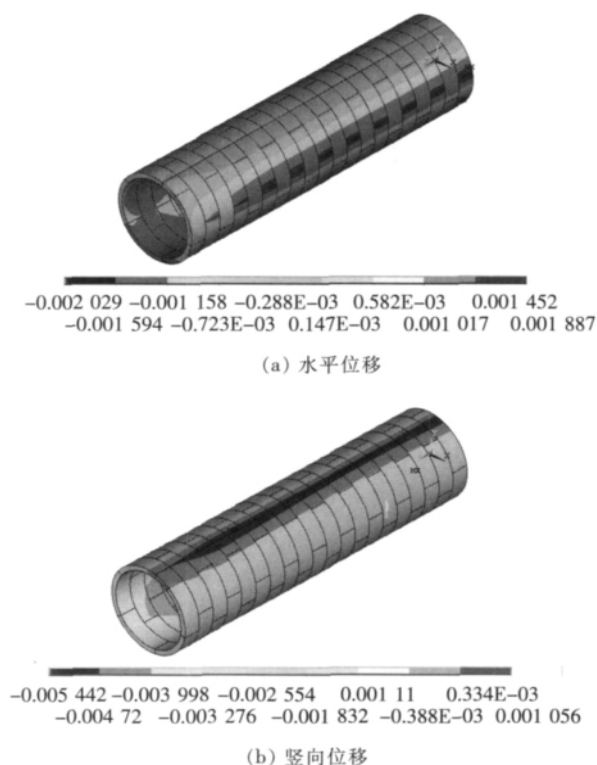
图 7 管片错缝拼装位移云图(单位: m)
