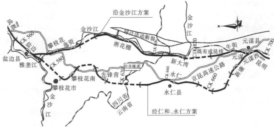
图 1 盐边至元谋段走向方案比较示意图
