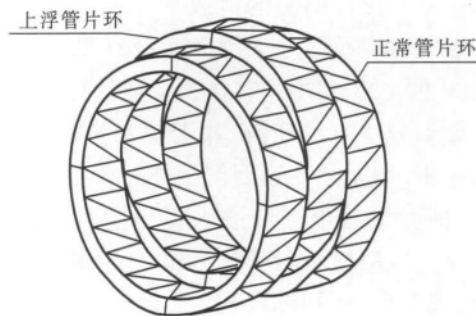
图7 单环管片上浮示意图
