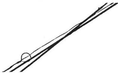
图 2 两支交叉承力索悬挂安装图
